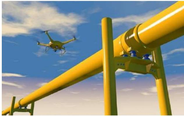
*Figure 30: Exemple de drone d'inspection de pipelines*
