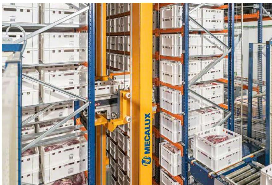
*Figure 3. L'automatisation est l'un des axes de la chaîne d'approvisionnement 4.0. Sur la photo, un transstockeur pour bacs ou miniload [6].*
