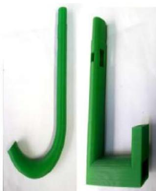
Figure 22 : Exemples de réalisation par fusion au travers d'une buse chauffante, source D. Comberton
